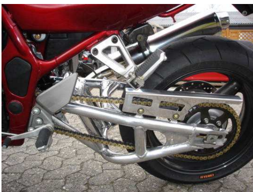
Suzuki GSF 1200 Turbo 100 mm länger, Kettenspanner 80 mm
